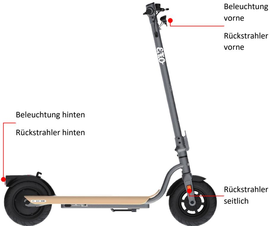
Die Beleuchtung des Fahrzeugs besteht aus dem weißen LED-Hauptscheinwerfer vorne und der roten LED-Beleuchtung mit Bremslichtfunktion hinten. Verwenden Sie diese unbedingt bei schlechten Sicht- und Lichtverhältnissen.
