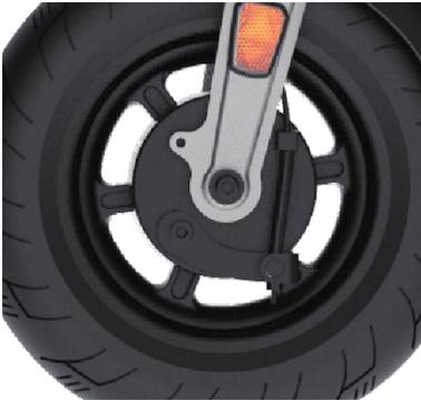
Das Bremssystem verzögert durch eine mechanische Trommelbremse vorne und eine Motorbremse hinten. Die Trommelbremse kann durch die Einstellschraube am Seilzugspanner eingestellt werden. Je mehr diese angezogen wird desto stärker bremst der E-Roller beim Betätigen des Handbremshebels. Wird der Bremshebel betätigt schaltet der Motor ab. Ersetzen Sie einen neuen Bremsbelag, wenn  $\frac{2}{3}$  davon abgenutzt ist und die Bremswirkung
