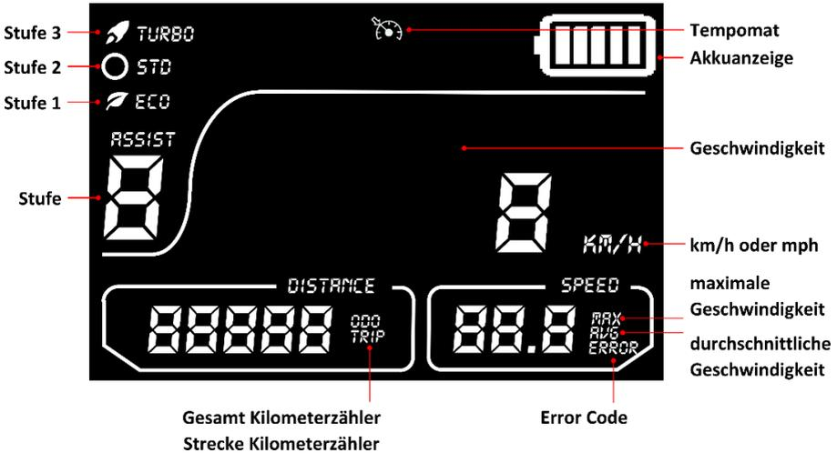
**Akkuanzeige:** Die Anzeige für den Ladezustand der Batterie wird durch fünf Balken im Batteriesymbol angezeigt, die beim Entladen der Batterie von links nach rechts reduziert werden. Fünf Balken bedeuten, dass der Batteriestand zwischen 100% und 80% liegt, vier Balken bedeuten, dass der Batteriestand zwischen 80% und 60%, und so weiter.
