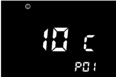
Programm 1: Stellen Sie den korrekten Felgendurchmesser ein. Der Wert des ES500 sollte auf 10c (10 Zoll) (Abb. 1) eingestellt sein. Der Wert kann mittels +/- Taste angepasst werden.
