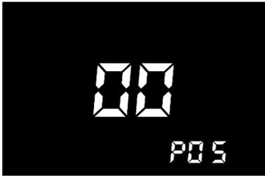
Programm 5: Stellen Sie den Wert mittels ‚+/-‘ Taste auf 00 oder 01. Wert 00: Der Roller startet sofort, wenn der Gashebel betätigt wird. Wert 01: Der Roller startet erst wenn dieser nach vorne bewegt wird.
