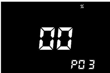
Programm 3: Stellen Sie die maximale Geschwindigkeit mittels ,+/-' Taste von 1% bis zu 100% (Wert im Display 00) ein.
