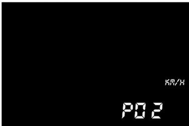
Programm 2: Stellen sie die Geschwindigkeit mittels ,+/-' Taste auf km/h oder mph ein.
