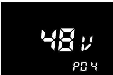
Programm 4: Stellen Sie mittels ,+/-' Taste die richtige Batteriespannung ein. Diese sollte beim Modell ES500 auf 48V eingestellt sein.
