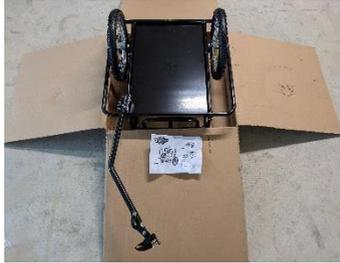
Auf der Unterseite wird auch die Zugstange befestigt. Dadurch, dass auch hier eine Schraube und ein Federbügelbolzen verwendet werden, ist diese Stange klappbar.
