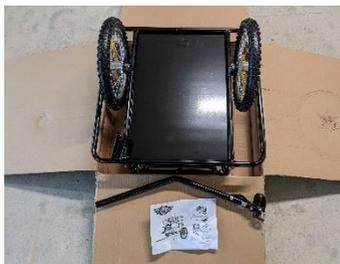
Montieren Sie die zwei Räder und ziehen Sie die mitgelieferten Schrauben ordentlich an.
